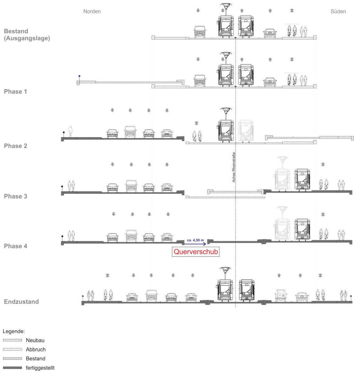
Abbildung 4: Bauablaufkonzept Brücke Rheinstraße (zusammengefasste Hauptbauphasen)
