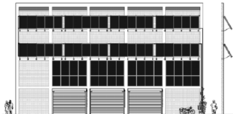
Abbildung 3: Visualisierung der geplanten Solarkollektoren am Kesselhaus
